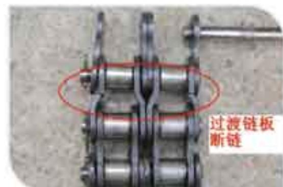
图5 过渡链板断链
