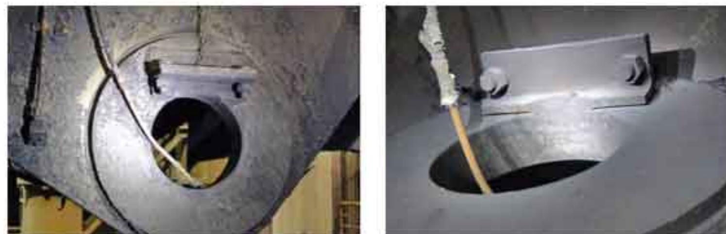
图4 东侧A、B 端L型卡板的弧形凹槽
