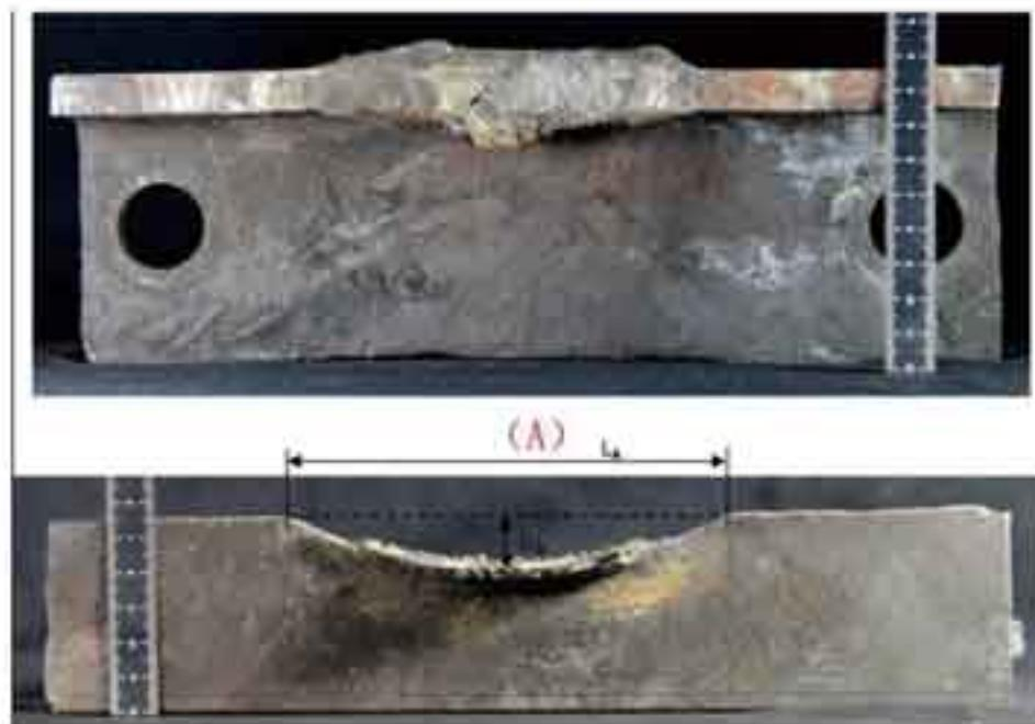
图10 A卡板损伤形貌
