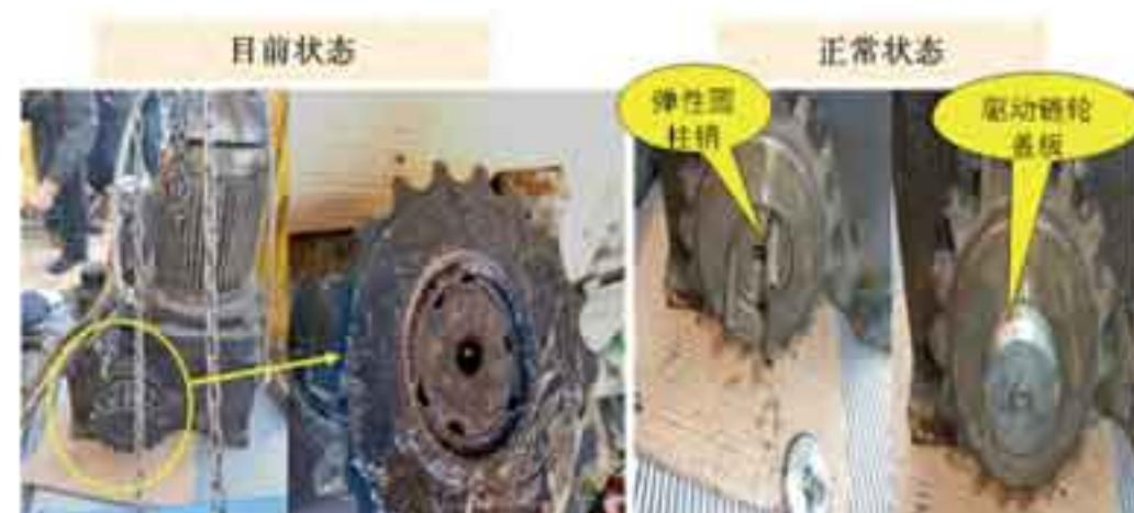
图4 脱落的弹性圆柱销
