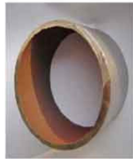
图2 窗口状爆口附近管段内表面
