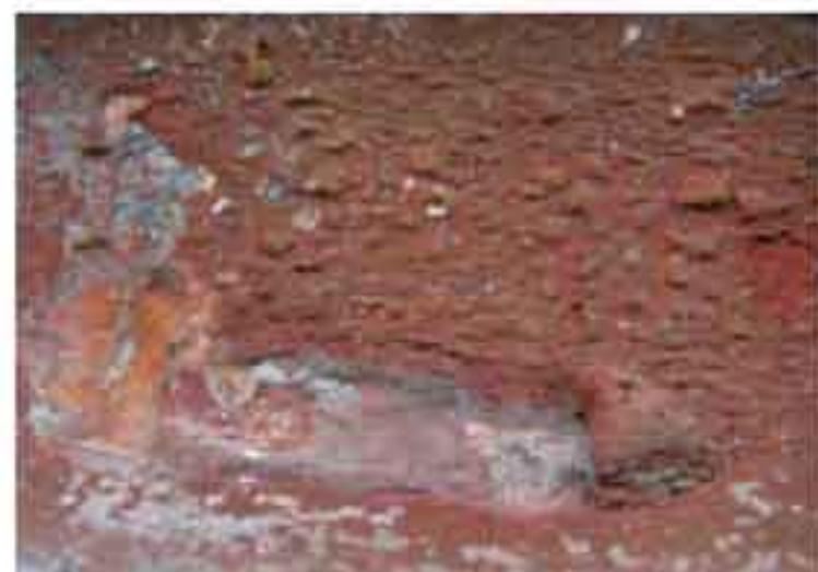
图5 除去内表面腐蚀产物后的管样基底面貌
