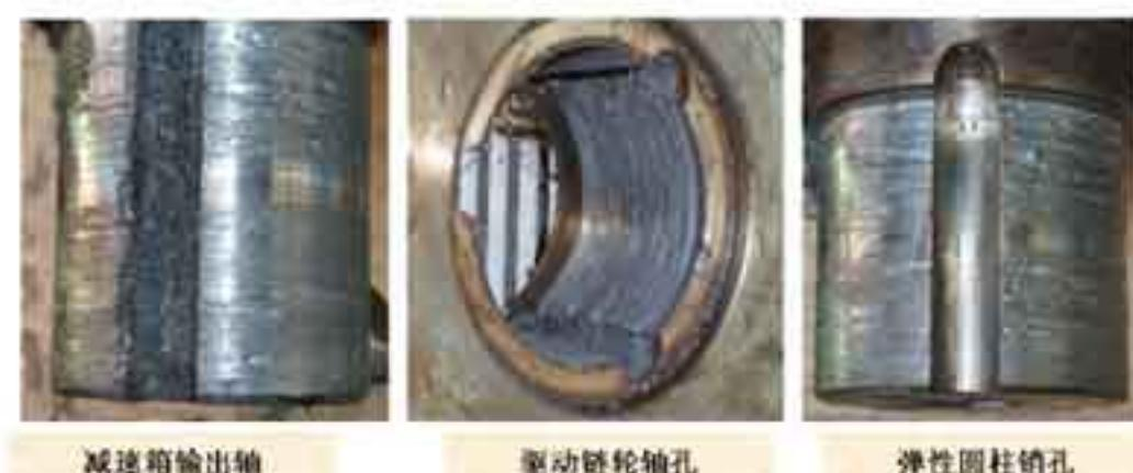
图5 减速箱输出轴外表面及驱动链轮轴孔内表面磨损痕迹
