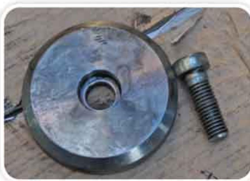
图3 散落在机坑内的减速箱驱动链轮盖板及固定螺栓
