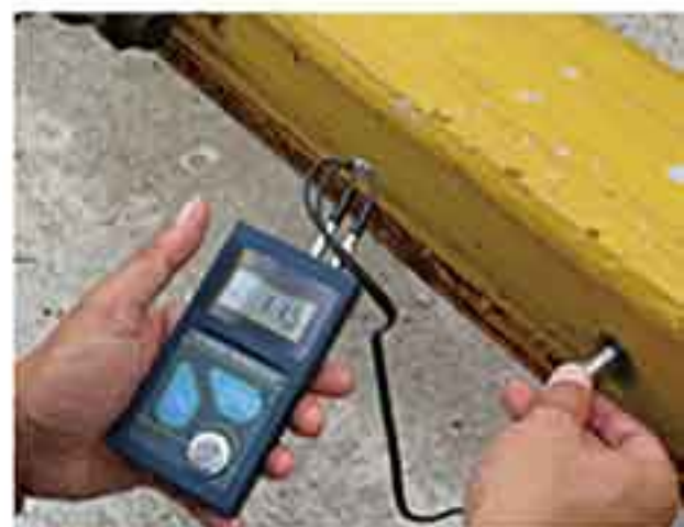
图 7 主弦杆超声波测厚
