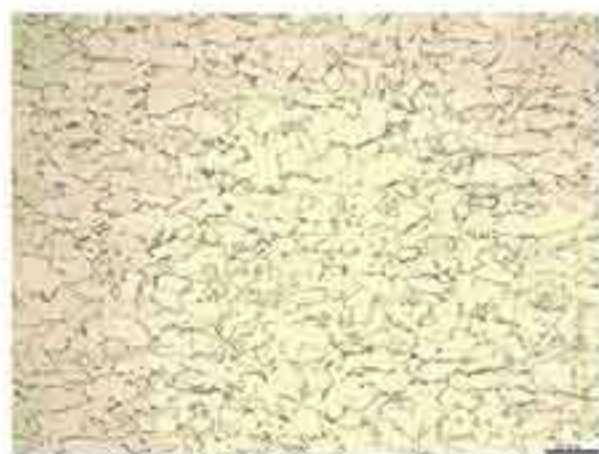
图 1 X60 直缝埋弧焊管母材金相组织
