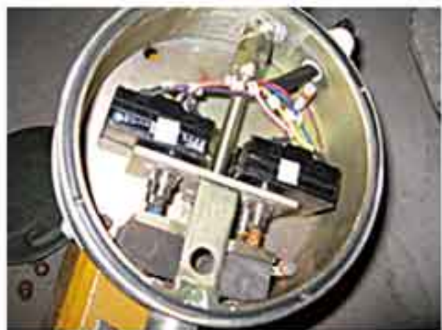
图 8 力矩限制器内部检查
