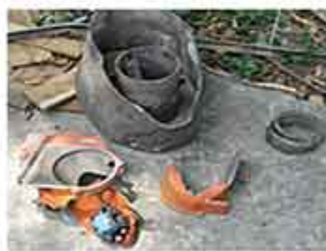
图3 在70多米外找到的部分锅炉残片
