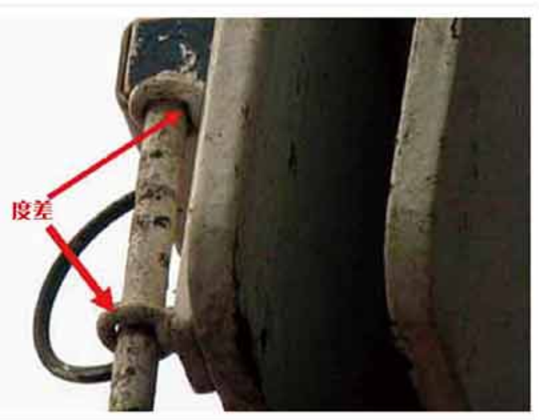
图6 金属感应杆定位精度差
