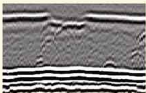
图 1 上表面裂纹的 TOFD 图像
