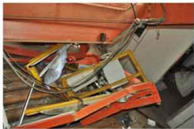
图4 起重机驾驶室严重变形
