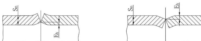
图 3 环焊缝轴向棱角高度示意图
